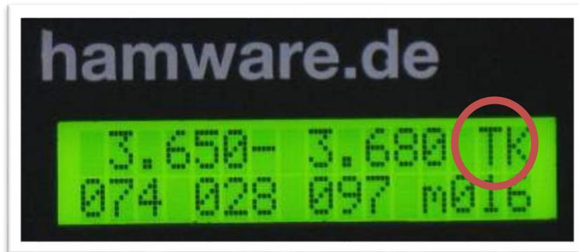
In diesem Mode werden mit den Drehgebern **TRX**, **L** und **ANT** die Komponenten des Tuner eingestellt. Mit dem Drehgeben **Manual** kann der gewünschte Speicherkanal gewählt werden, in welchen die Drehgeberdaten beim Drücken des Schalters **Memory-Tune-MemIn** in die Stellung **MemIn** geschrieben werden. Das Konfigurationsdaten zur Speicherung anstehen, wird durch die Anzeige des Buchstabens **M** visualisiert.
