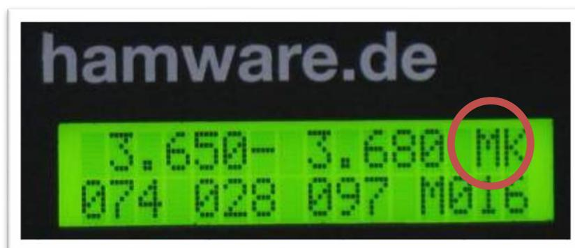
In dieser Stellung ist nur der ganz rechte Drehgeber **Manual** aktiv. Über diesen wird der gewünschte Speicher ausgewählt. Die gespeicherten Stellungen der Drehgeber TRX, L und ANT sowie die gewählte Speichernummer wird in der unteren Displayzeile angezeigt.
