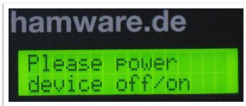
Nun muss das Steuergerät aus- und dann wieder eingeschaltet werden.
