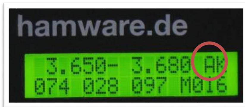
In dieser Stellung haben alle Drehgeber keine Funktion, sondern der Speicherkanal wird durch Schnittstellendaten des angeschlossenen Transceivers gesteuert.
